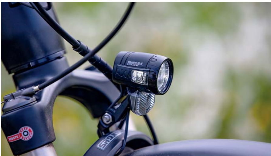
Světlo je napájené z baterie elektrokola.
